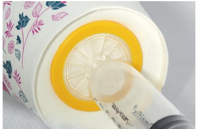
**Abb. 7** Filter und Becher in Verbindung mit dem Spritzenkörper
